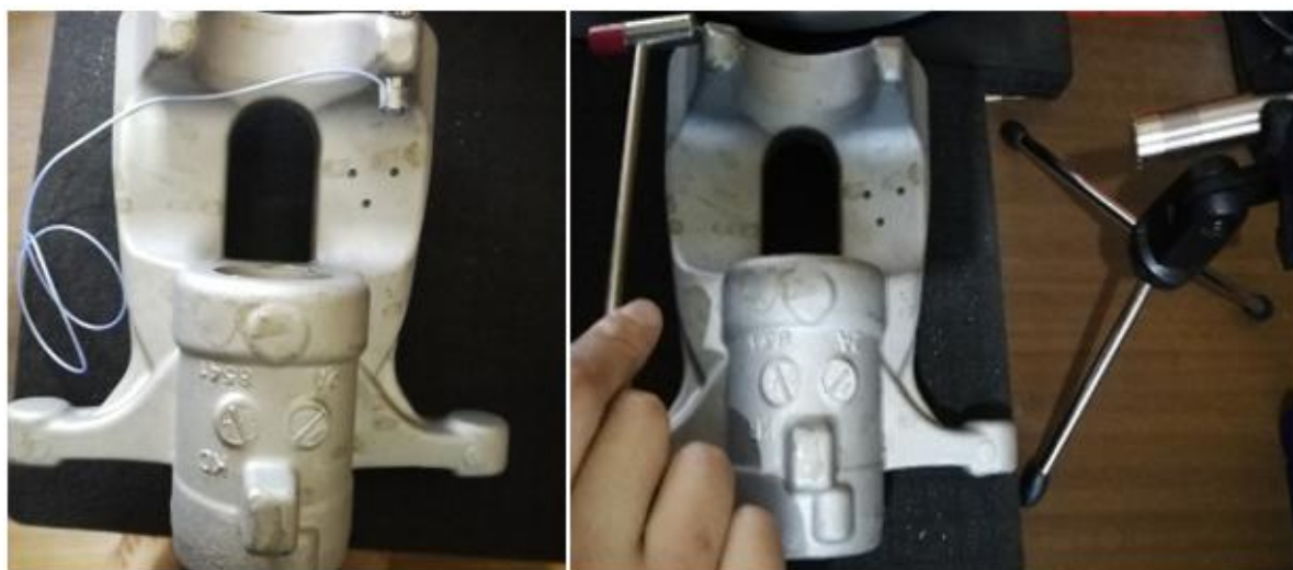
图 8 左图使用微型加速度传感器测试 右图使用宽频传声器测试
