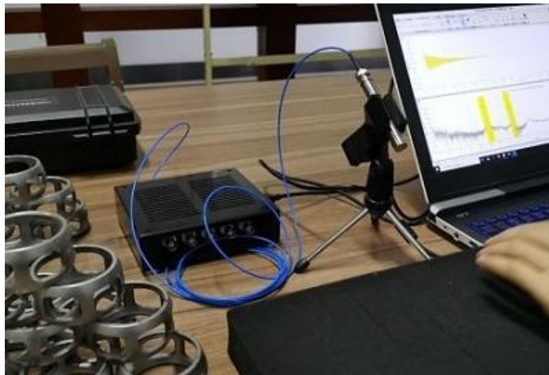
图 13 TYH801 用于铸件裂纹检测
