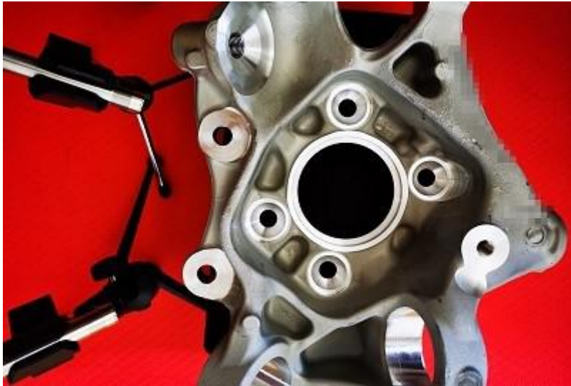
图 14 TYH801 用于转向节固有频率测试
