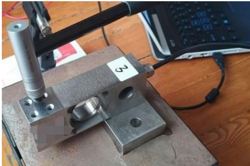
图 15 TYH801 用于载荷传感器固有频率测试
