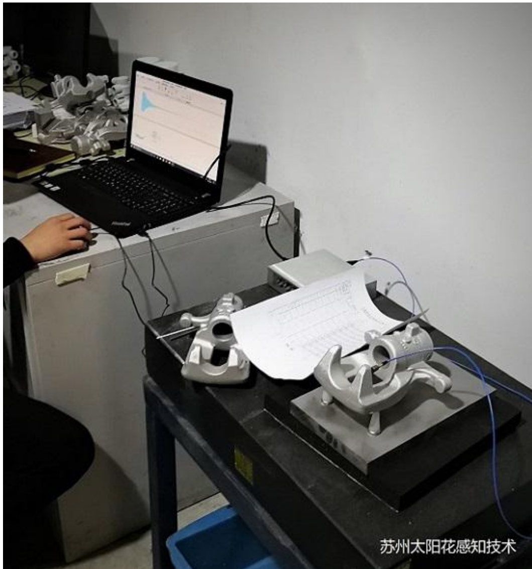
图 7 刹车卡钳固有频率测试现场
