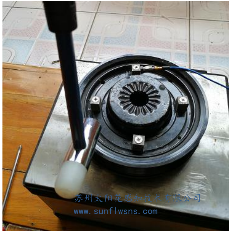
图 1 惯性环扭曲振动固有频率测试（锤击方向和传感器敏感方向成 90°）
