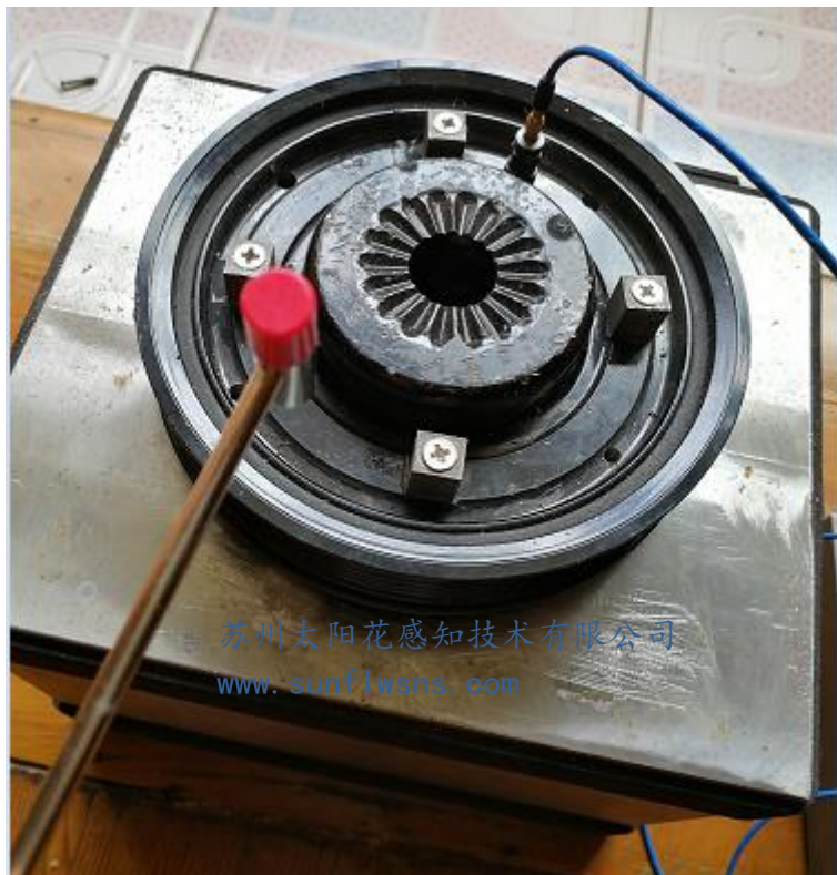
图3 惯性环垂直方向振动固有频率测试（锤击方向和传感器敏感方向一致）
