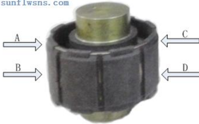
图 4 通过传感器的黏贴位置和力锤的敲击位置找到目标频率
