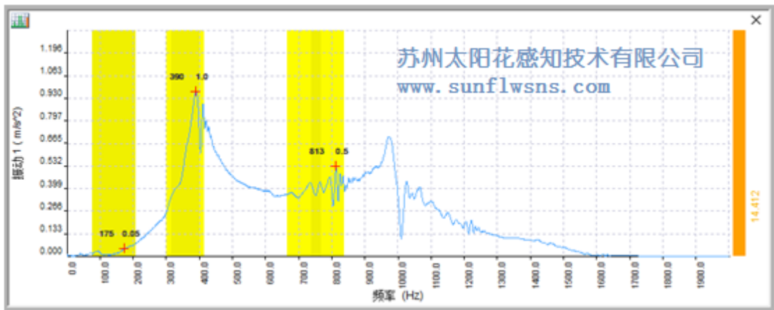
图 5 加速度传感器的黏贴位置 B 和力锤的敲击位置 D 的试验结果 (没有发现 139Hz 附近有任何峰值)
