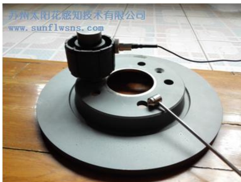
图 3 用 AB 胶把减振环牢固地粘接在固有频率已知的刹车盘上
