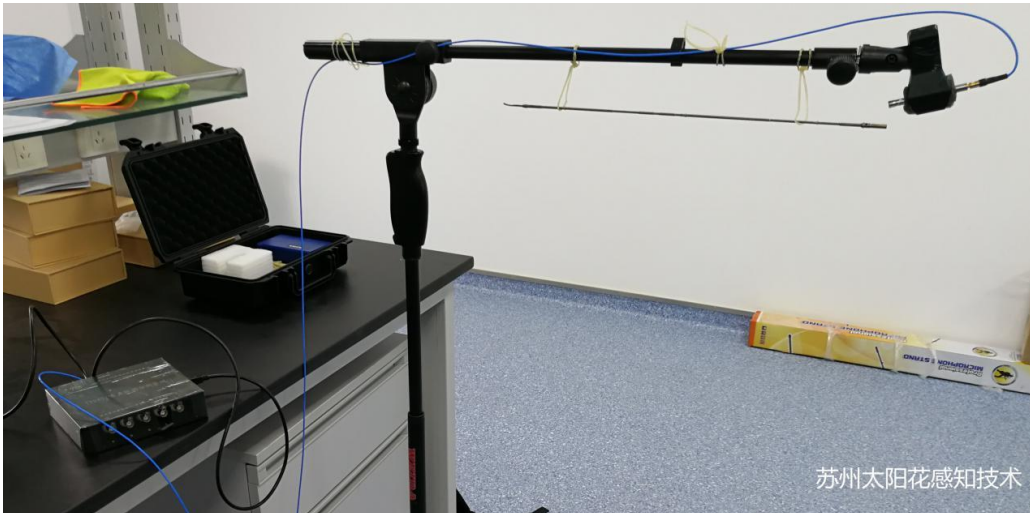
图 1 将手术刀软橡皮绳悬挂
