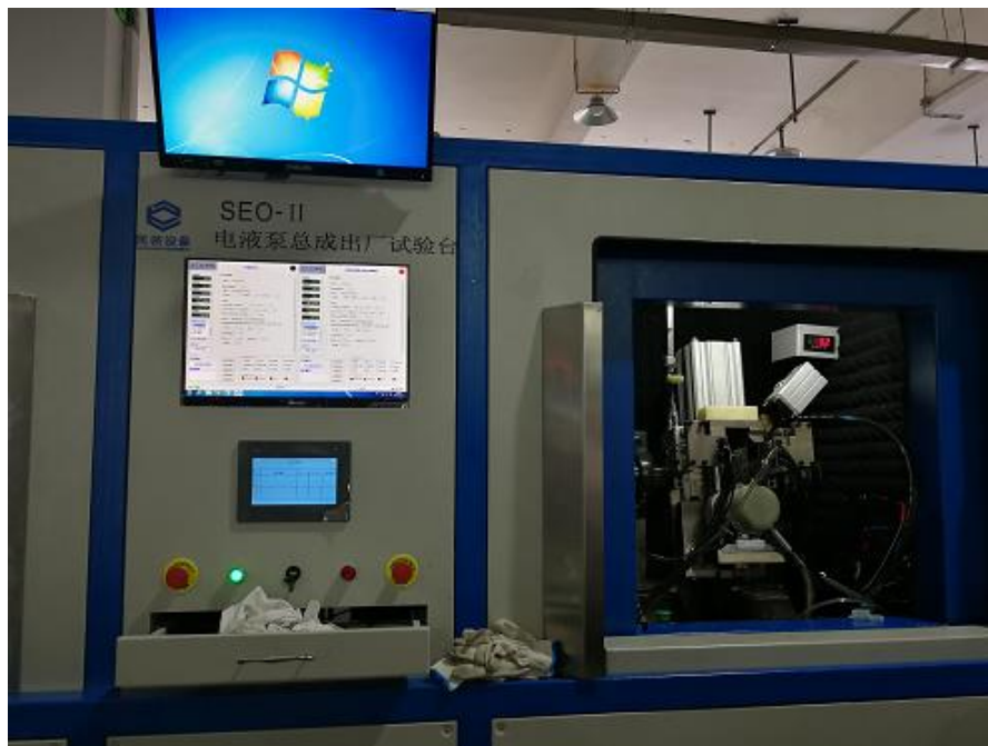
图 3 TYH801 噪声振动测试系统集成于总成双台架测试生产线中
