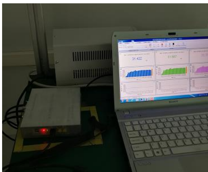
图 2 消声室外控制台上的 TYH801 噪声振动分析设备
