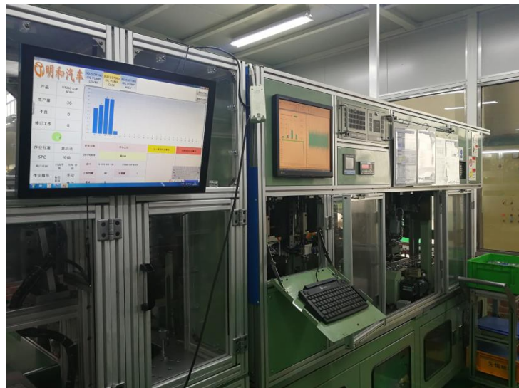
图 6 TYH801 噪声振动测试设备集成于生产线测试单元（2）
