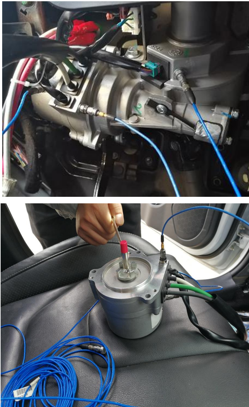
图 4 TYH801 噪声振动测试系统现场测试 EPS 电机的振动
