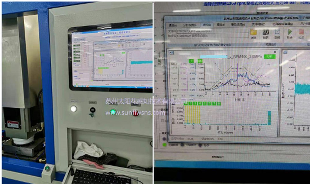
图8 TYH801 振动测试系统在测试台的应用实例（变转速变压力振动测试）
