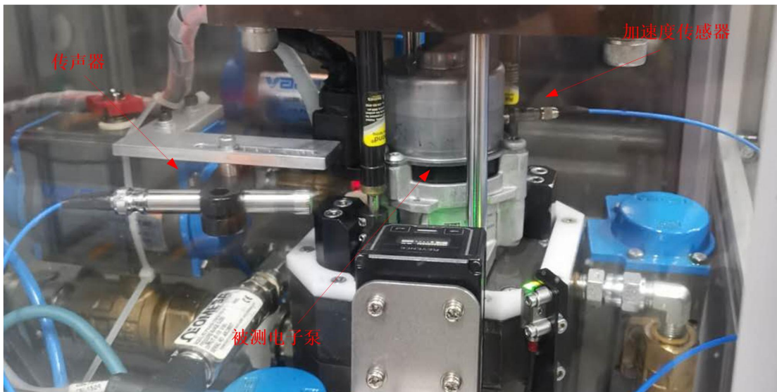
图 1 测量工位上被测泵和传感器位置
