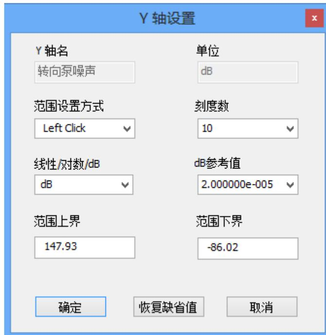
图 43 1/3 倍频程子视图 Y 轴设置
