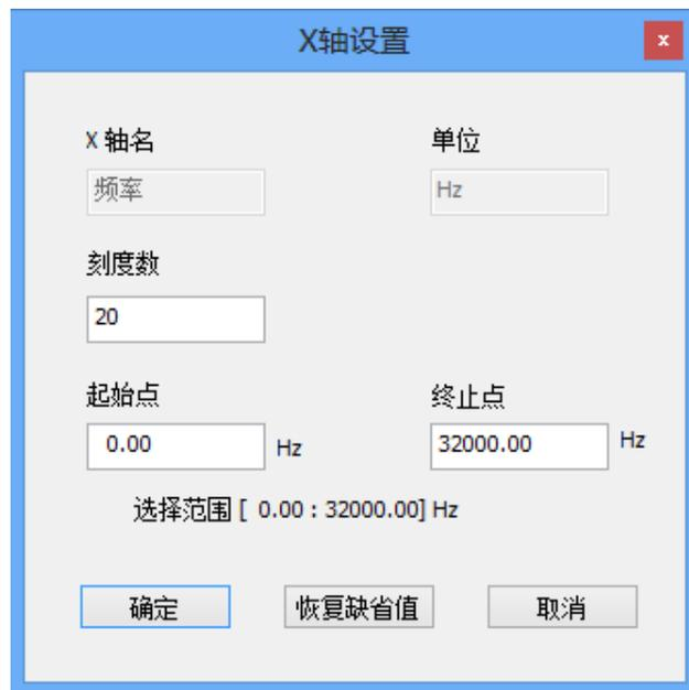
图 31 频谱（RMS）子视图 X 轴设置
